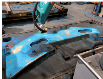
Nettoyage moule en fonderie.
