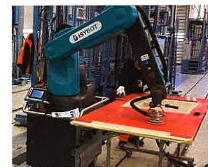
Der interaktive Schleif-Cobot von Isybot entlastet Mitarbeiter vor monotonen und körperlich anstrengenden Arbeiten.
