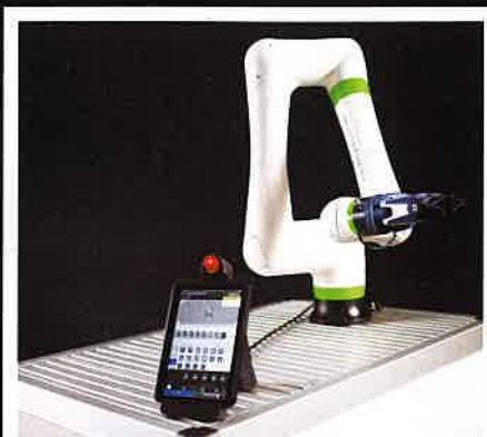
Um die Zusammenarbeit zwischen Mensch und Maschine zu vereinfachen, verfügt der Roboter über ein Tablet als Programmiergerät.
