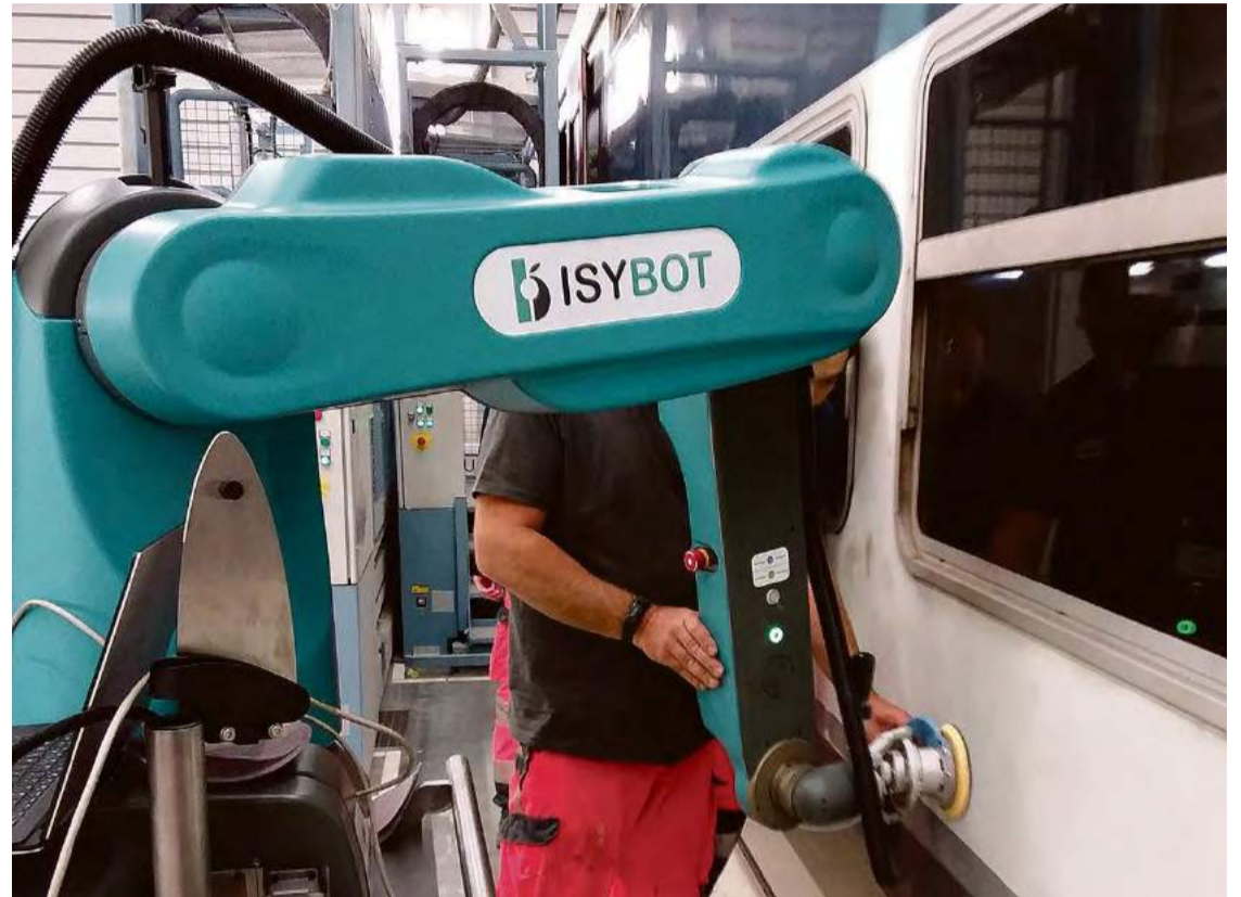
Ce robot va faciliter les opérations de ponçage des rames de RER et de métro. ISYBOT
